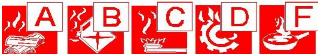
Slika br.1.- Klasifikacija požara
